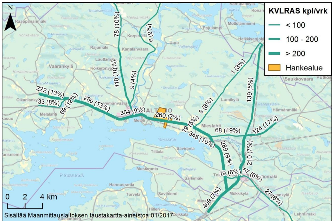
Kuva 6-19. Liikennemäärät vuonna 2016 (KVL: keskimääräinen vuorokausiliikenne). Ylempi kuva: kaikki liikenne, alempi kuva: raskas liikenne. Raskaan liikenteen osuus kaikesta liikenteestä on esitetty prosenttiosuuksina. Tiedot: Liikennevirasto 2017.
